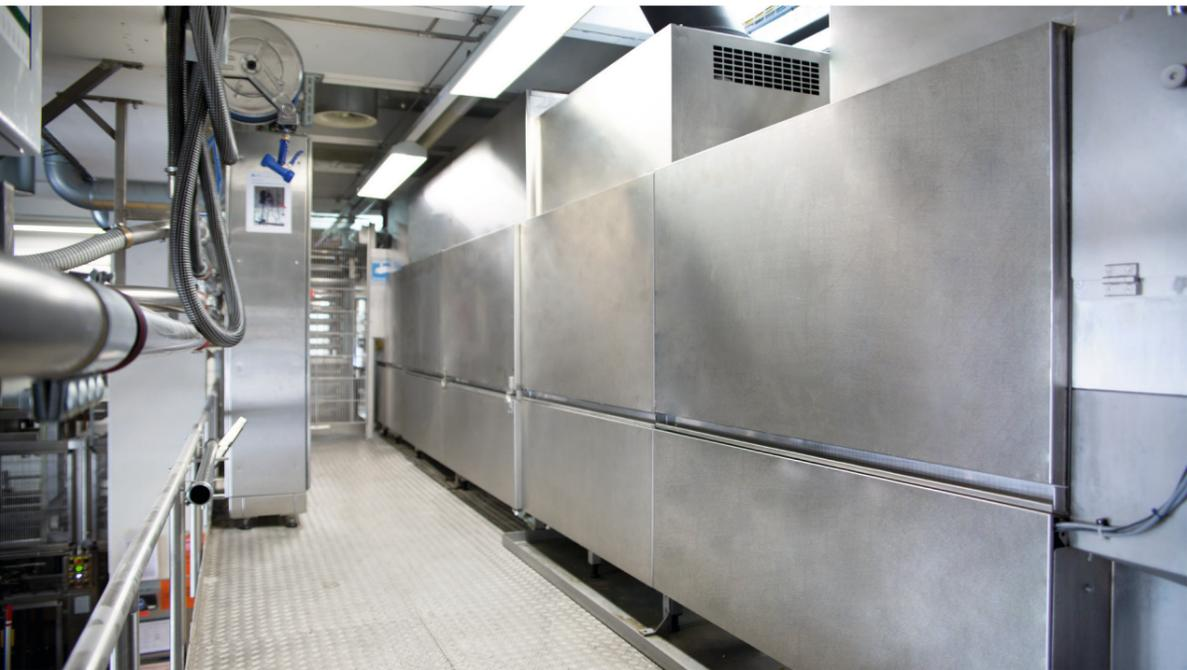
Die Hobart Reinigungsanlage ist direkt in die Produktionslinie integriert und sorgt für die automatisierte Reinigung der Backbleche.
